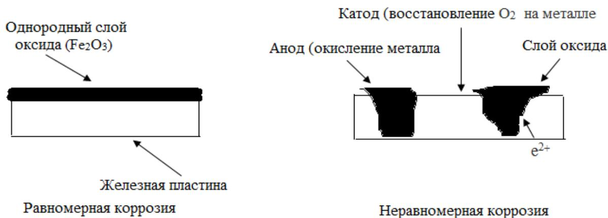
Рисунок 1 – Два вида влажной коррозии
